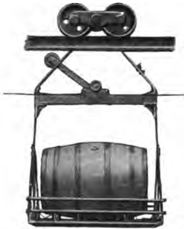
Abb. 202. Tonnenwagen (J. Pohlig, A.-G., in Cöln).
