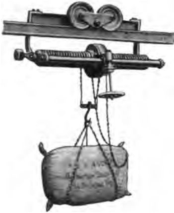
Abb. 200. Hängebahnwagen zum Transport von Kaffee, Reis, Getreide u. s. w. in Säcken für Magazine oder Lagerplätze, mit Windevorrichtung, zum Herablassen eingerichtet (A. Bleichert & Co. in Leipzig).
