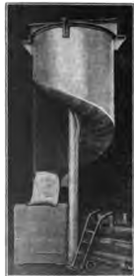
Abb. 614. Wendelrutsche von Dauber (R. W. Dinnendahl, A.-G., in Steele a. R.).
