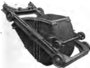
Abb. 243. Kübelkatze (3 cbm Inhalt) für Hochofenbegehung von A. Bleichert & Co. in Leipzig; vgl. Abb. 289.
