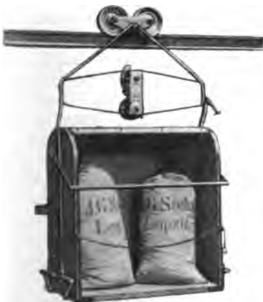
Abb. 201. Seilbahnwagen zum Transport von Mehl in Säcken mit Feststellvorrichtung auf dem Fußboden und mit Sicherung gegen Herabfallen der Säcke (A. Bleichert & Co. in Leipzig).
