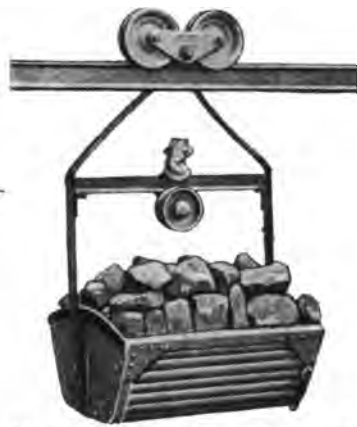
Abb. 203. Seilbahnwagen zum Transport von Bruchsteinen. Der Kasten ist wegen der starken Abnutzung mit leicht auswechselbaren Holzknöpfeleinlagen versehen (A. Bleichert & Co. in Leipzig).
