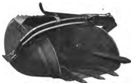
Abb. 254. Brownscher selbstfüllender Schaufeleimer.
