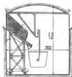
Abb. 606. Fahrbarer Füllrumpfvorschluss im Gaswerk Tegel-Dalldorf.
