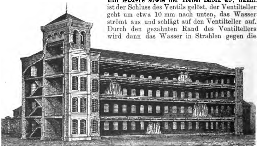
Abb. 648—650. Speicher mit selbsttätiger Feuerlöschbrause, System Grinell (Walther &amp; Co. in Kalk bei Cöln).
