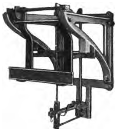
Abb. 227. Bleicherts selbsttätige Schnellwage für Seil- und Hängebahnen.
