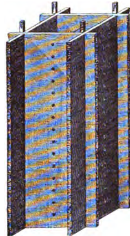
Abb. 656. Amerikanische Silowände aus Holzbrettern.
