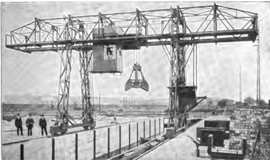
Abb. 361. Dreimotoren-Bockkran der Benrather Maschinenfabrik, A.-G. (Tiefbauamt Charlottenburg).
