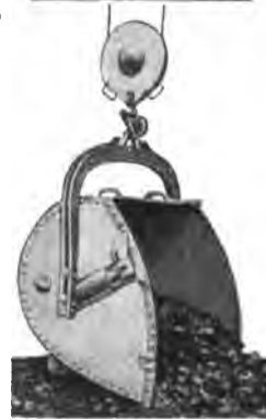
Abb. 241 u. 242. Bleichertsche selbstentleerende Förderkübel.
