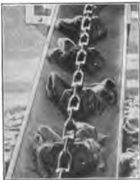
Abb. 524. Schleppe für Häute (Link-Belt Eng. Co. in Philadelphia, bzw. W. Fredenhagen in Offenbach a. M.).
