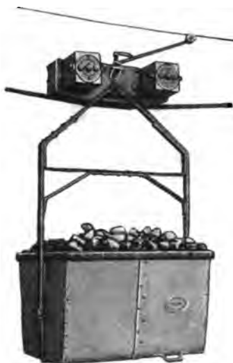
Abb. 164. Elektroseilbahnwagen mit zwei Fahrmotoren von A. Bleichert & Co. in Leipzig.
