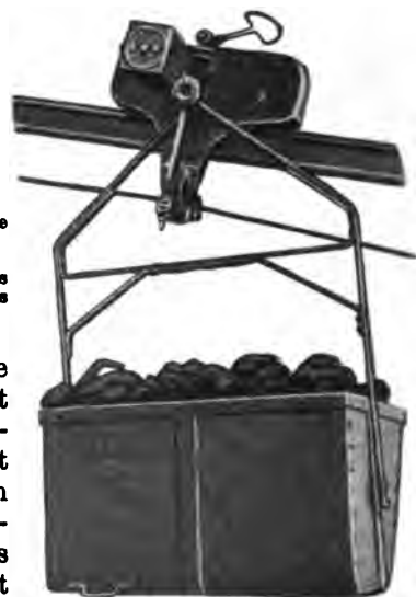
Abb. 165. Elektrohängebahnwagen mit Fahrmotor und Unterseilkupplung für Seilrampenbetrieb von A. Bleichert & Co. in Leipzig.
