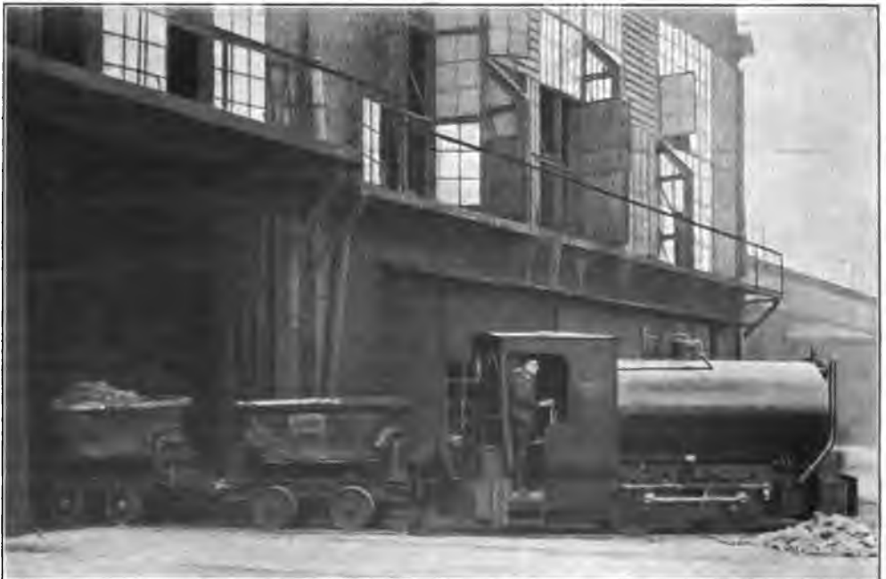
Abb. 76. Borsigsche „Feuerlose Lokomotive“.
