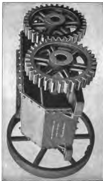
Abb. 491. 20pferdiger Brecher mit Stahlgusszähnen (gekapselt).
