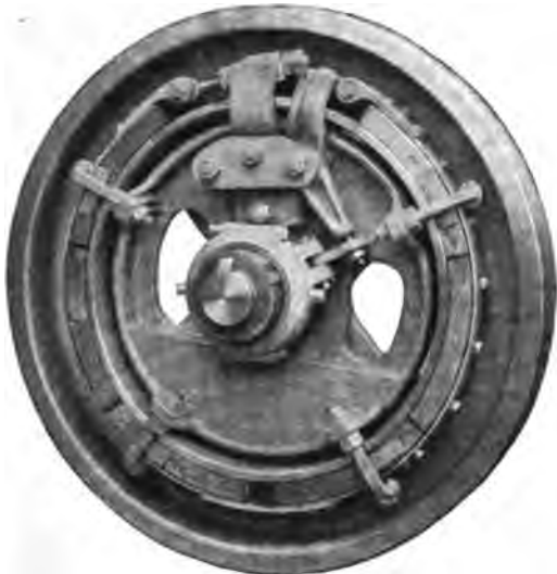
Abb. 369. Reibungskupplung für Seiltrommeln von A. Bleichert & Co. in Leipzig.
