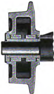
Abb. 564. Zapfenschmierung für Konveyorräder (Bamag).
